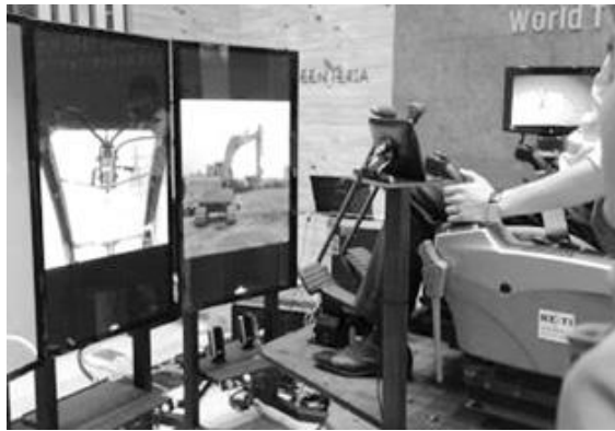
Excavator simulator (KETI)
